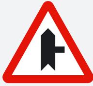
Intersección con prioridad sobre vía a la derecha
