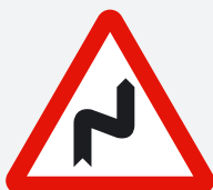
Curvas peligrosas hacia la derecha
